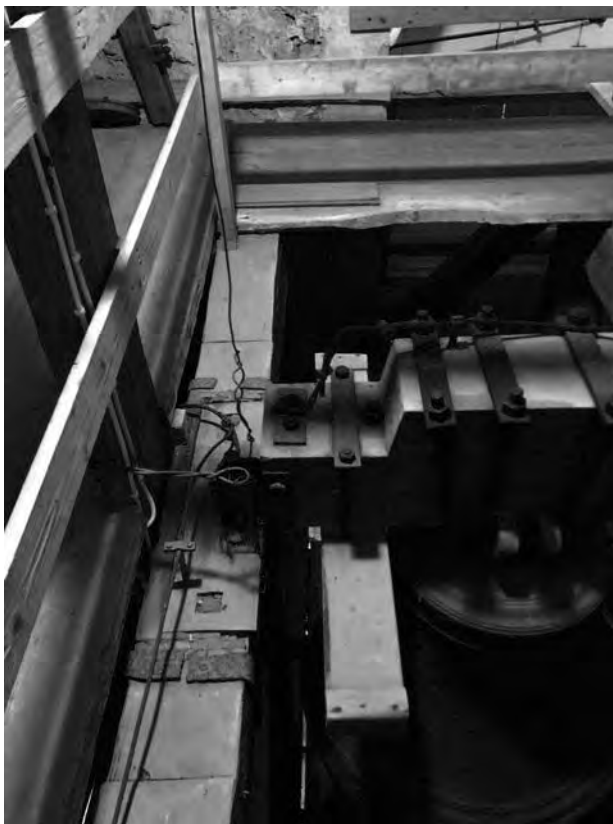
Kyrktornet i Lerbäck med trampmekanismen för kyrkklockorna.
